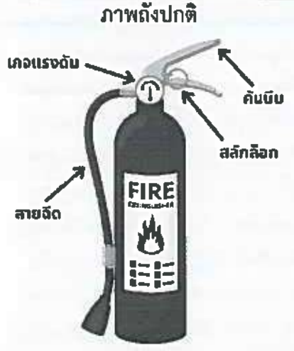
หมายเหตุ: ถังดับเพลิงชนิดคาร์บอนไม่มีเกจแรงดัน
